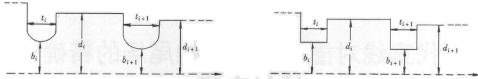
图1 下一代直线对撞机的一种失谐加速结构
