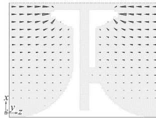
图3 \pi/2 模时轴向电场分布图(电边界)
